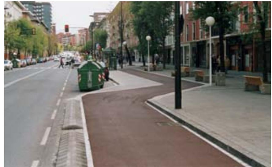
**Imagen III. 4-4: Senda-bici del tipo carril-bici protegido que se transforma en senda acera-bici a su paso por la parada de bus (Bilbao)**
